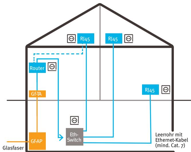
Für die Umlegung der Glasfaser-Teilnehmeranschlusssdose in den Wohnraum bieten wir Ihnen ein vorkonfiguriertes Installationskit bestehend aus der Gf-TA und einer 30 m langen Glasfaserleitung für die Eigenmontage an. Bei Bedarf erstellen wir Ihnen ein individuelles Montageangebot.
