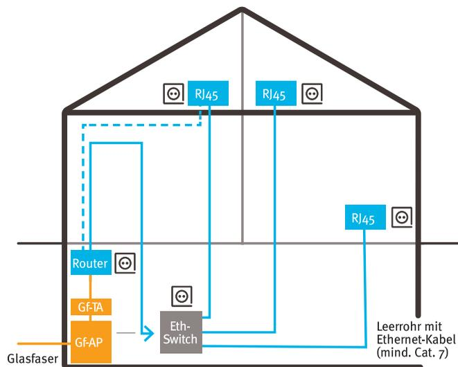
Für die Nutzung Ihres Glasfaseranschlusses sind zwei Geräte notwendig, deren Platzierung abhängig von der Gebäudestruktur und der Raumnutzung ist:
